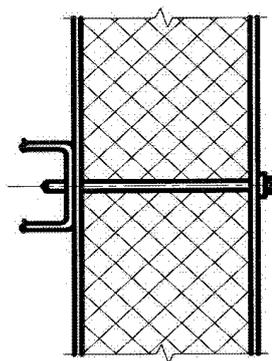
a - фрагмент конструкции покрытия со стальным профилированным настилом и схема действия сил на опорах (1 - соединения в среднем участке; 2 и 3 - соединения соответственно по продольным и поперечным полкам; 4 - соединения в месте пересечения продольных и поперечных полок);
